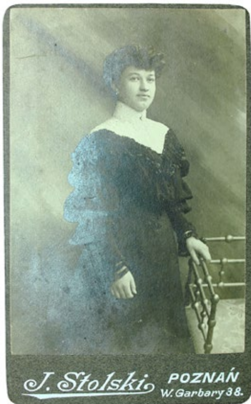
Fot. 3. Zdjęcie dokumentacyjne historycznej odbitki z charakterystycznym lustrem srebrnym (fot. K. E. Niedzielska)
